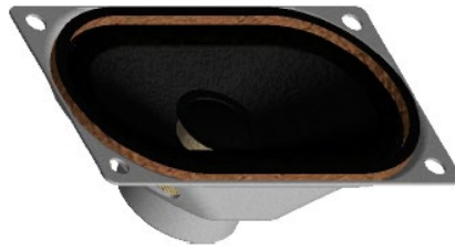
Рисунок 11 – Внешний вид встроенного динамика
