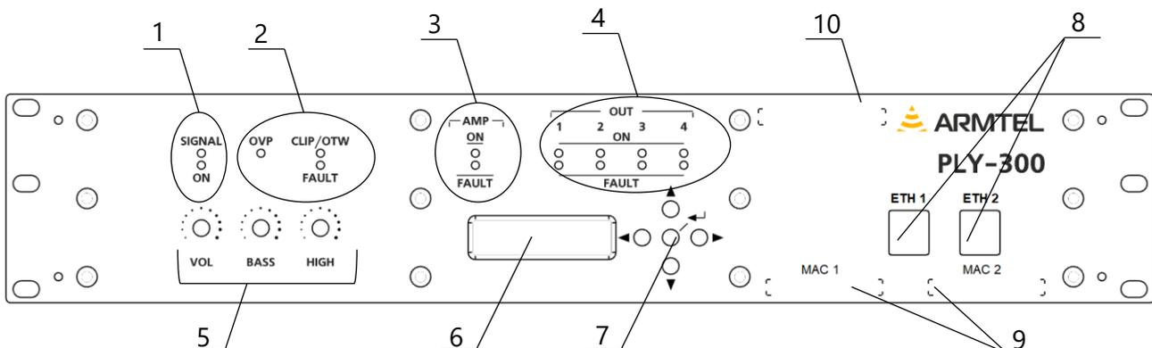
1 – индикаторы входного и управляющего сигналов; 2 – индикаторы сработавших защит основного усилителя; 3 – группа индикаторов «AMP»; 4 – группа индикаторов «OUT»; 5 – регуляторы; 6 – OLED-дисплей; 7 – кнопки для работы с экранным меню; 8 – разъемы «ETH1», «ETH2»; 9 – место маркировки MAC-адреса; 10 – место маркировки серийного номера
