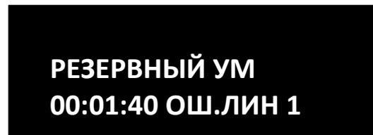
в) неисправность основного усилителя (резервный усилитель включен), ошибка на линии 1
