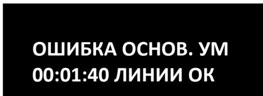
б) неисправность основного усилителя (резервный усилитель не включен)
