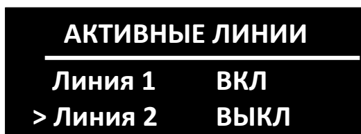
Рисунок 5 – Подключение линий оповещения
