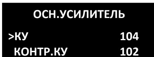
Рисунок 19 – Измеренный и контрольный коэффициент усиления для основного усилителя
