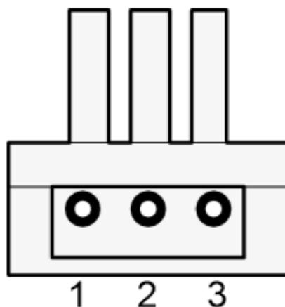
*1 - 48 В от источника питания; 2 - 0 В от источника питания; 3 - GND для подключения заземления корпуса IPN-8U, должен быть подсоединен к общей шине заземления шкафа (стойки).*
