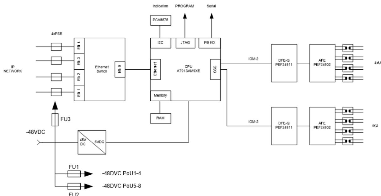
Рисунок 4 – Блок-схема IPN-8U
