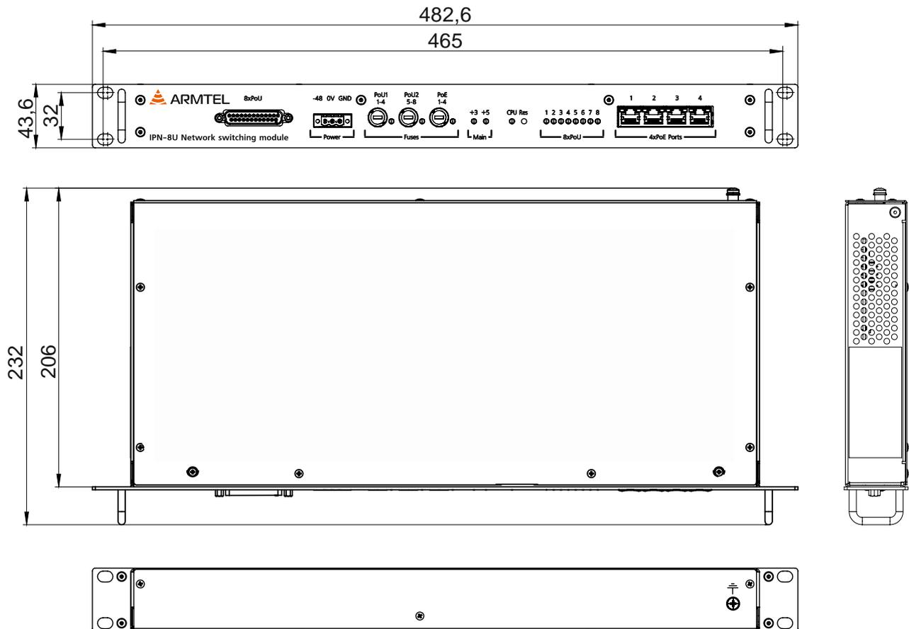
Рисунок 1 – Внешний вид и габаритные размеры IPN-8U
