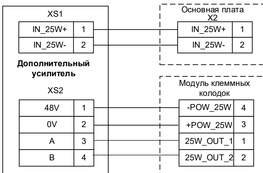
Рисунок Б.1 – Схема внутренних соединений для подключения дополнительного усилителя
