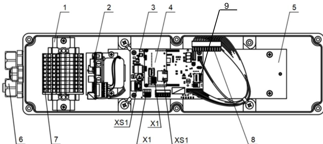
1 – DIN-рейка, 2 – усилитель 25 Вт, 3 – плата CCS-DW-IP2, 4 – плата NE01, 5 – шасси,
