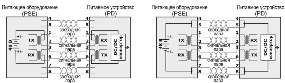
Рисунок Б.1 – Схема организации дистанционного питания
