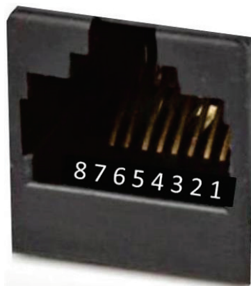
Рисунок А.3 – Внешний вид и нумерация контактов разъема интерфейса Ethernet ETH1
