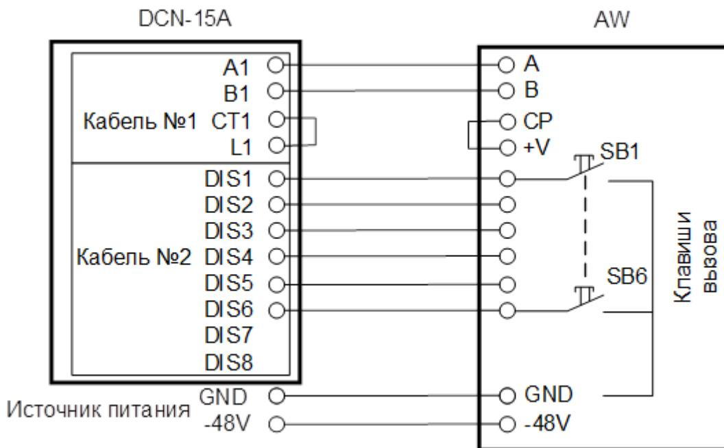
Рисунок A.2 – Подключение к DCN-15A аналогового
