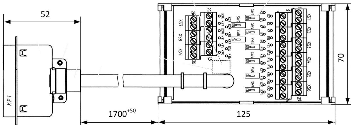
Рисунок A.1 – Кабель подключения DCN-15A
