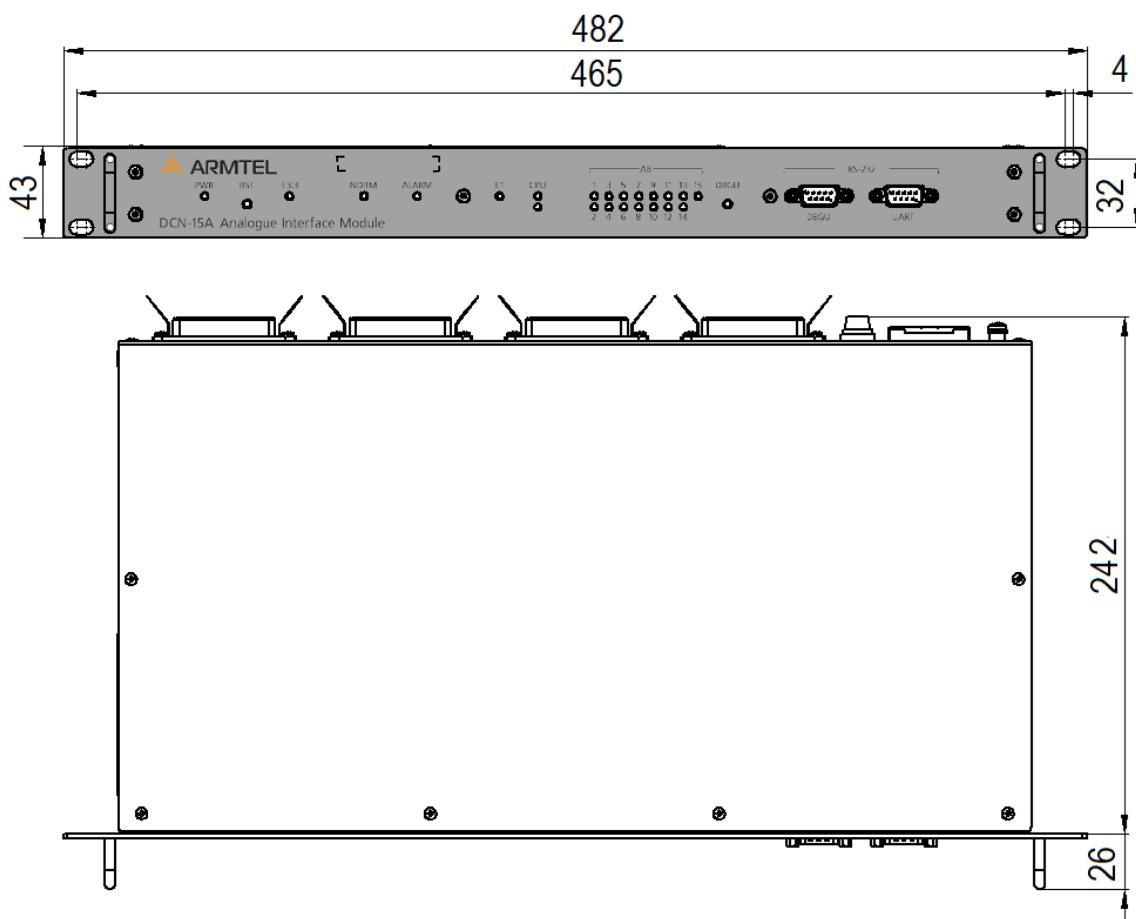
Рисунок 2 – Внешний вид и габаритные размеры DCN-15A
