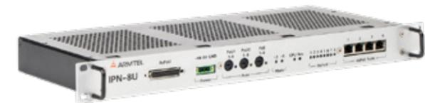
IPN-8U обеспечивает подключение до восьми цифровых абонентских устройств с  $U_{k0}$ -интерфейсом к IP-сети (возможно подключение только устройства типа DIS, DW, DWEx и МАП). Подключенные к нему абоненты, могут связываться напрямую друг с другом и с другими абонентами IP-сети, не требуя наличия специальной централи или сервера.
