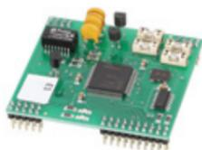
Модуль ISDN PRI (E1) предназначен для подключения коммутатора DCN-16U к центральному коммутатору DCN-2 или DCN-Q4E (обязательное оснащение).
