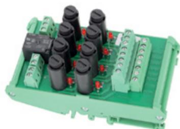
Универсальный модуль на 8 предохранителей предназначен для ограничения силы постоянного тока до 3 А при номинальном напряжении 48 В в каждом из восьми каналов питания потребителей и обеспечения выдачи сигналов неисправности. По умолчанию в модуль устанавливаются предохранители на 2 А (предохранитель плавкий 5x20 2 А 250 В)
