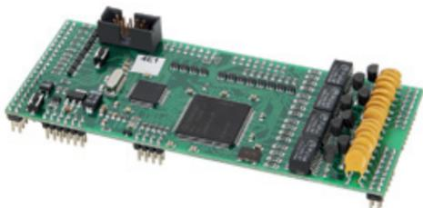
Плата 4E1 DCN-2 предназначена для формирования четырех потоков E1. Коммутатор DCN-2 может оснащаться от 1 до 4-х таких плат (опционально).
