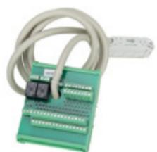
Кабель подключения цифровых абонентов DCN-16U предназначен для подключения к коммутатору DCN-16U пятнадцати абонентских устройств, оснащенных цифровым интерфейсом U, потока E1 и выдачи сигналов аварии A1, A2.
